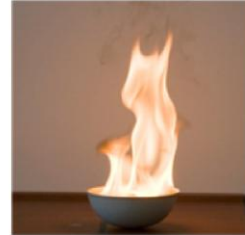
Flammen erlöscht nicht, da ausreichend brennbare Dämpfe sich entwickeln können
