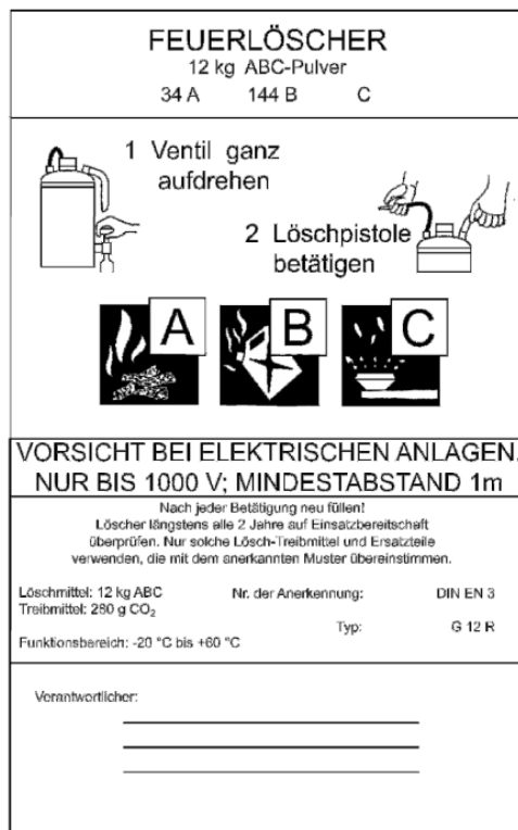
Pulverlöscher mit innenliegender Treibmittelflasche
